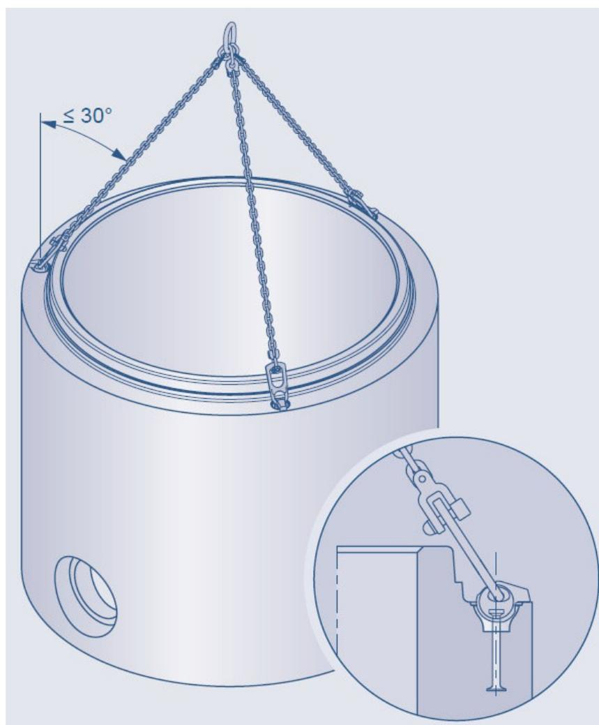
Die Lippenstellung des Philipp KK-Hebekopfes darf sich entgegengesetzt Der Zugrichtung befinden. Voraussetzung hierfür ist ein Schrägzug  $\leq 30^\circ$ .
