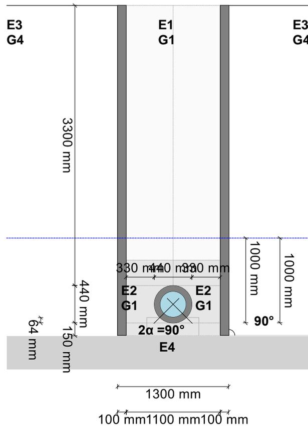
Hinweise Skizze: Einzelgraben mit Verbau. Rückbau des Verbau schrittweise beim Verfüllen und Verdichtung nach dem Ziehen sicherstellen!
