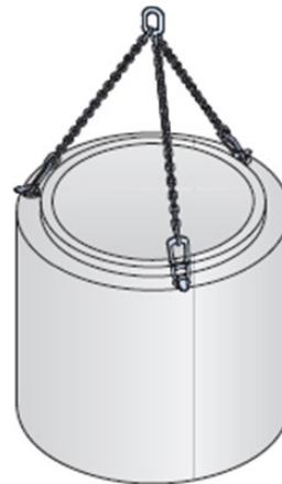
Bild 4: Anordnung des Transportankersystems am Spitzende (DEHA)
