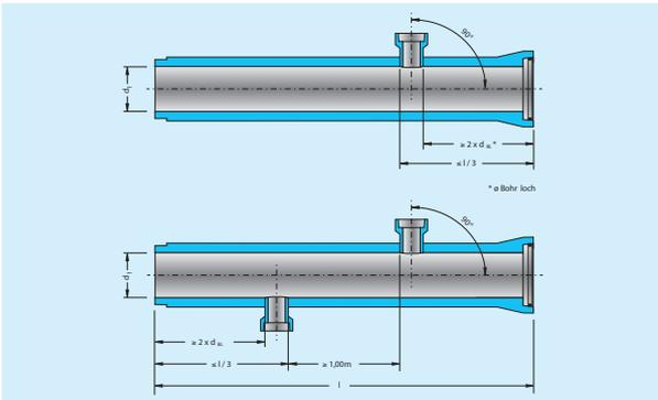
**Nachträglich herzustellende Anschlussöffnungen dürfen nur mit einem geeigneten Kernbohrgerät hergestellt werden.** Bohrung und Anschlussstutzen müssen aufeinander abgestimmt sein. Die Angaben der Hersteller von Rohren und Anschlussstutzen sind zu beachten. Der Anschlusspunkt sollte bei nicht begehbaren Kanälen bis DN 800 zwischen Kämpfer und Scheitel oder im Scheitel liegen.
