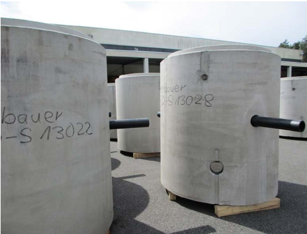
Die monolithisch im Werk gefertigten Schachtbauwerke DN 1500 konnten problemlos auf der Baustelle eingebaut und angeschlossen werden.
